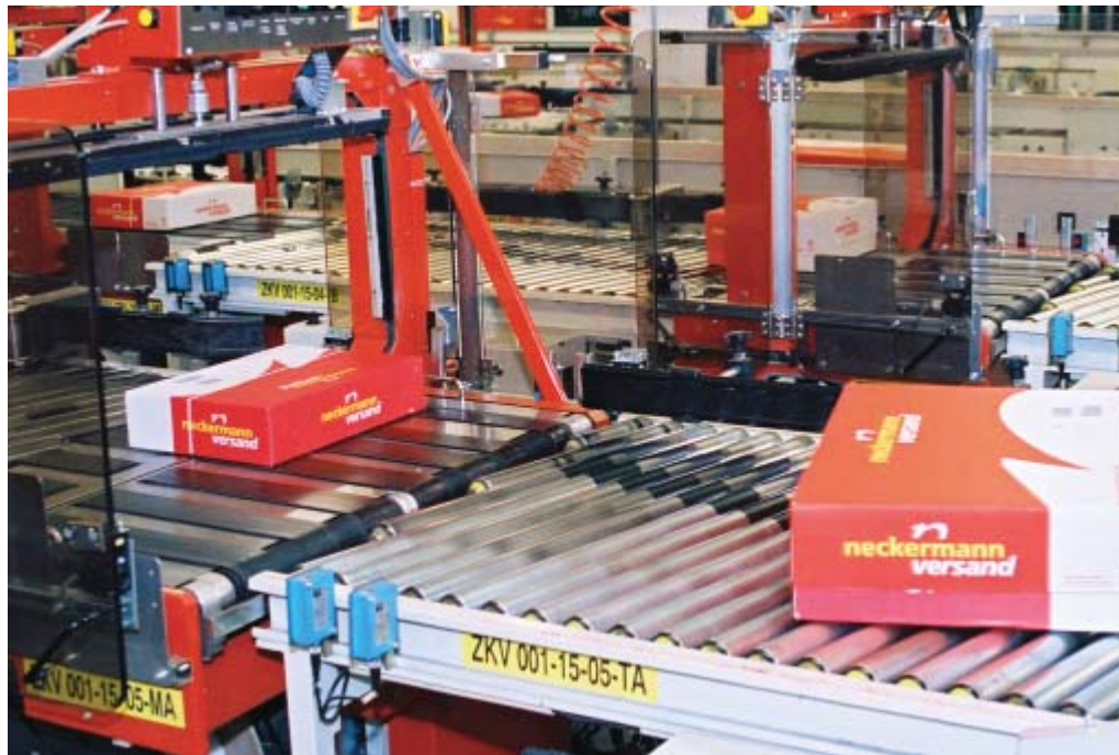
Auf der Verschnüranlage der Neckermann Versand AG werden die Waren maschinell verpackt
